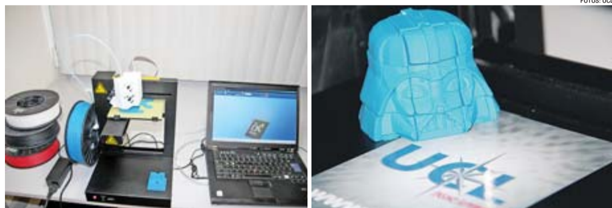
IMPRESSORA 3D criada na UCL utiliza resina para fazer protótipos, como a réplica do personagem Darth Vader
